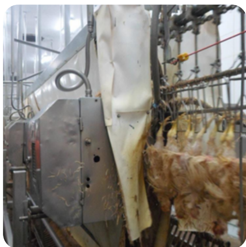
Figura 4.11. Depenadeira mecânica utilizada para remoção mecânica das penas durante o abate de aves
